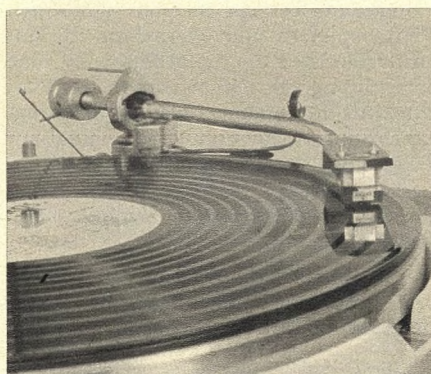
Bild 4. Skatingkraft-Detektor im Shure-SME-Tonarm bei unkomensierter Skatingkraft
